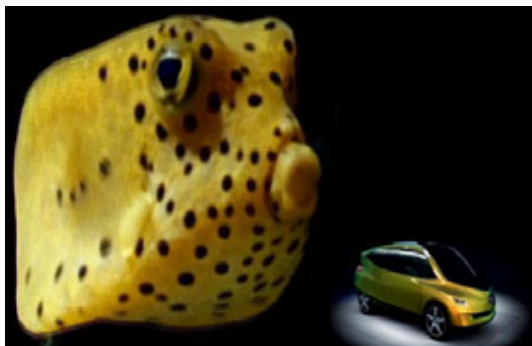
fig. 2 – Exemplo clássico de abordagem biomimética. Projecto de carro inspirado no peixe-cofre (arquivo do autor).
