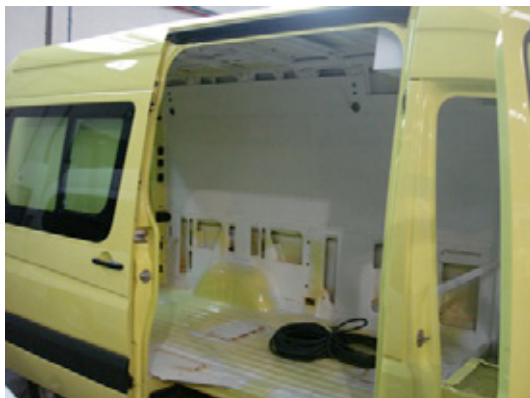
fig 5 – Início da transformação de veículo ligeiro de mercadorias em Ambulância SBV do INEM, modelo Volkswagen Crafter fonte: arquivo pessoal
